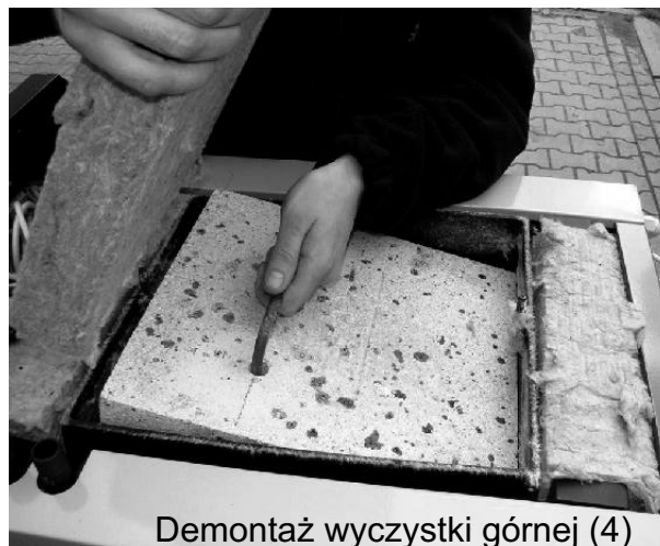
Demontaż wyczystki górnej (3)
