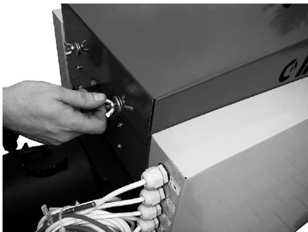
Demontaż wyczystki górnej (1)
