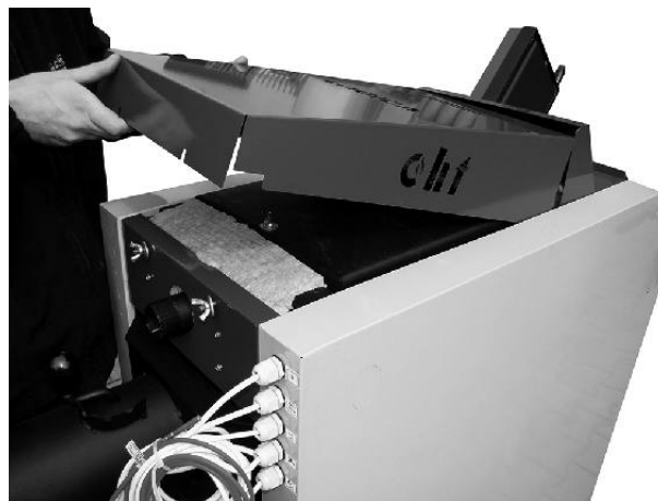
Demontaż wyczystki górnej (2)
