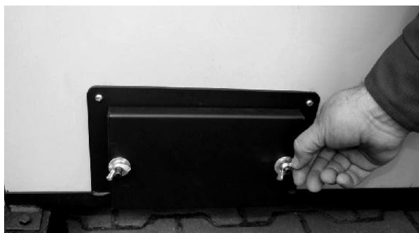
Demontaż wyczystki bocznej
